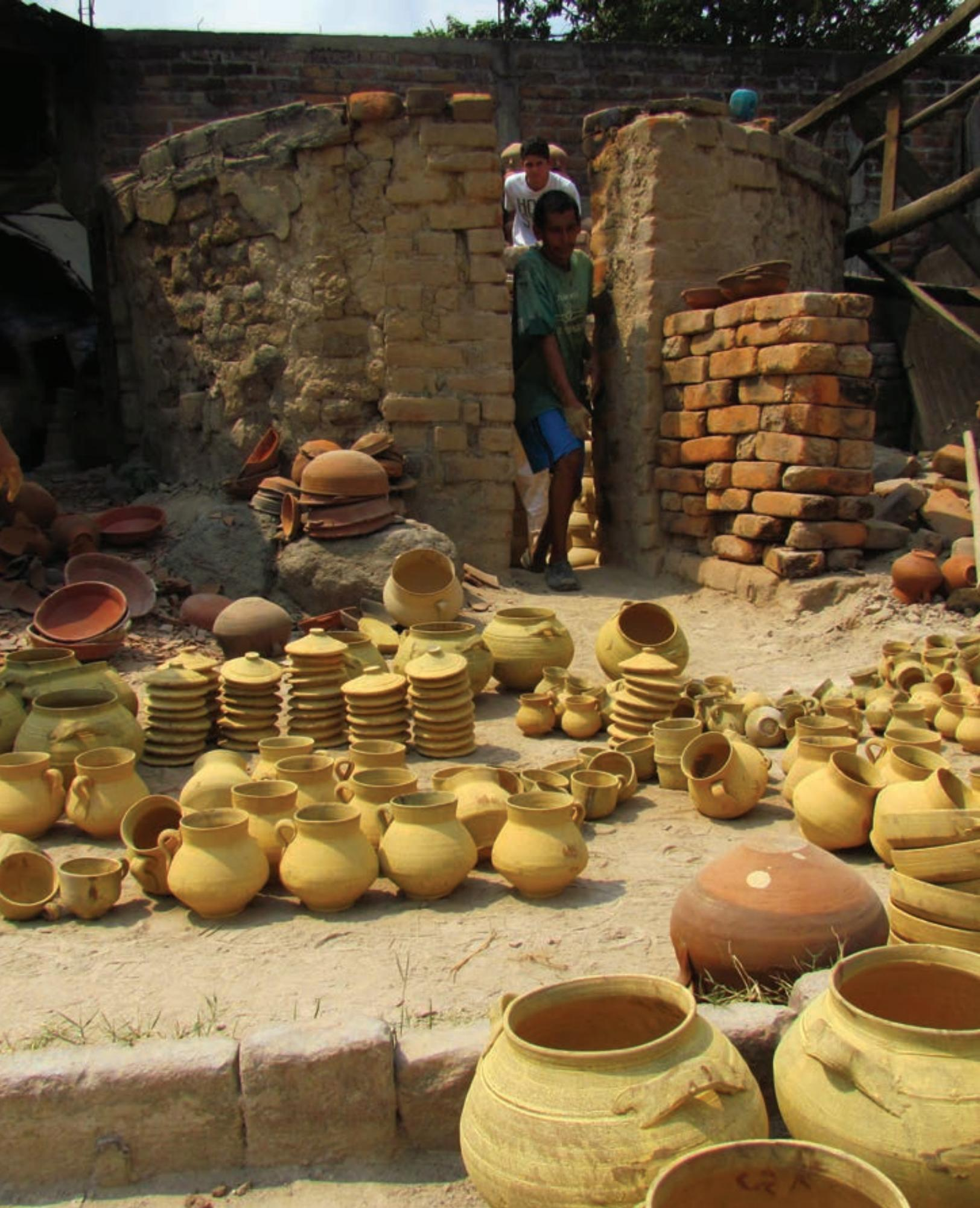
IMAGEN 11 - Piezas de cerámica, en el proceso de secado, para luego ser sometidas a la quema.
