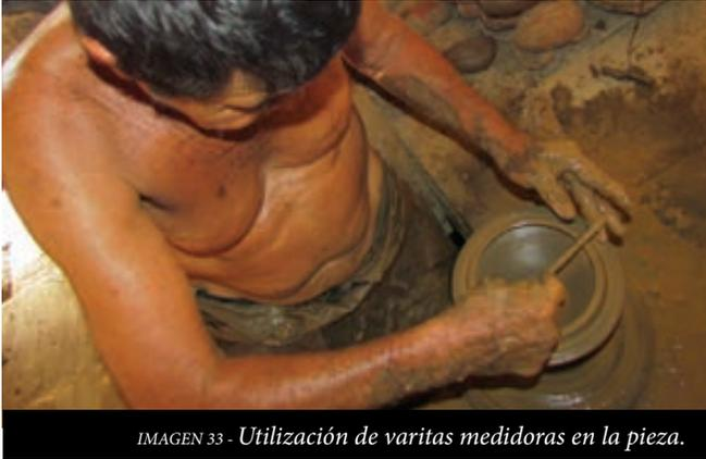
IMAGEN 33 - Utilización de varitas medidoras en la pieza.
