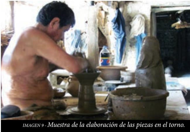
IMAGEN 9 - Muestra de la elaboración de las piezas en el torno.
