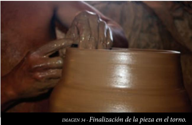
IMAGEN 34 - Finalización de la pieza en el torno.
