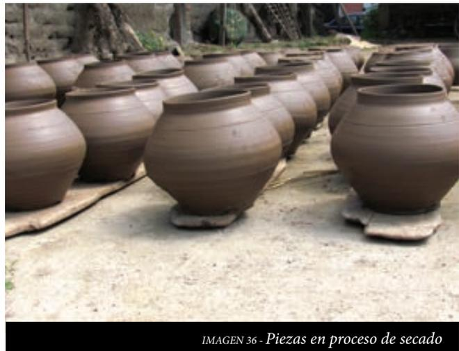
IMAGEN 36 - Piezas en proceso de secado
