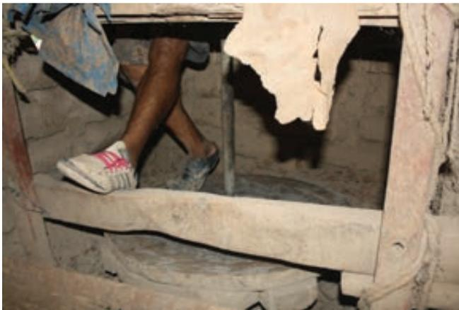
IMAGEN 28 - Disposición de los pies en el torno en movimiento.
