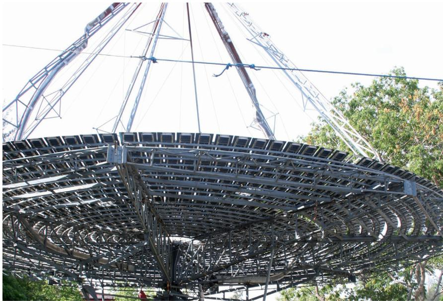
Ilustración 1 Colector para la generación de energía termo-solar desarrollado en la UDB.
