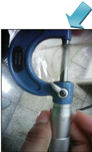
FIGURA C2 Medición del bioplástico
