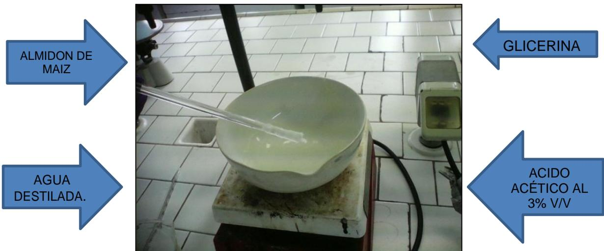
FIGURA B6. Calentamiento y mezclado de materias primas..
