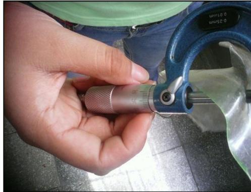
FIGURA C1 Ajuste del micrómetro.
