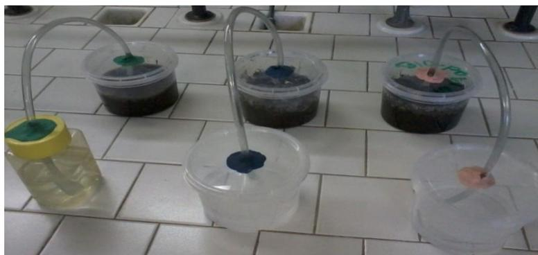
FIGURA D1 Mecanismo de prueba de biodegradabilidad
