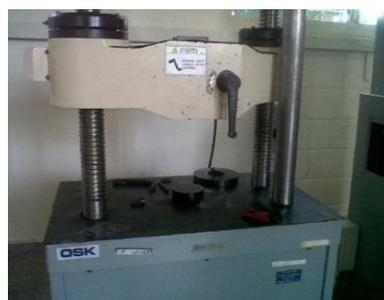
FIGURA F 2. Calibración del equipo
