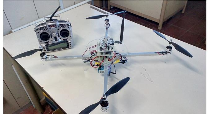
Figura 1. Arducopter diseñado y ensamblado
