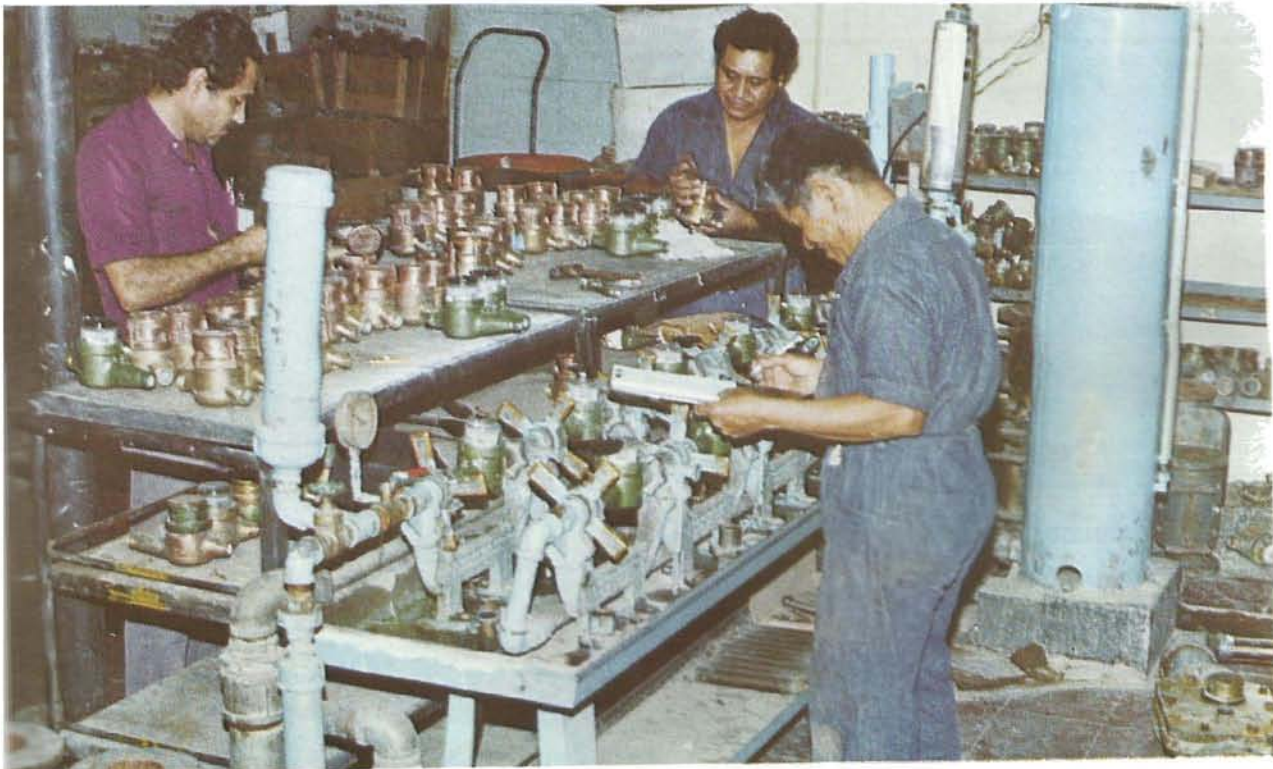
ASPECTOS DE REPARACION Y PRUEBA DE MEDIDORES
