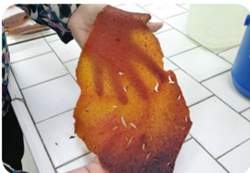
Prueba de pieza de lámina de bioplástico de fibra de coco y papaya.
