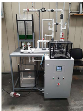
Entrenador en sistemas de bombeo
