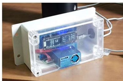
Estación de monitoreo de calidad del aire.
