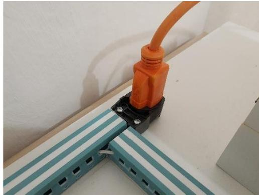
Figura 31. Conexión del módulo hacia alimentación eléctrica principal.
