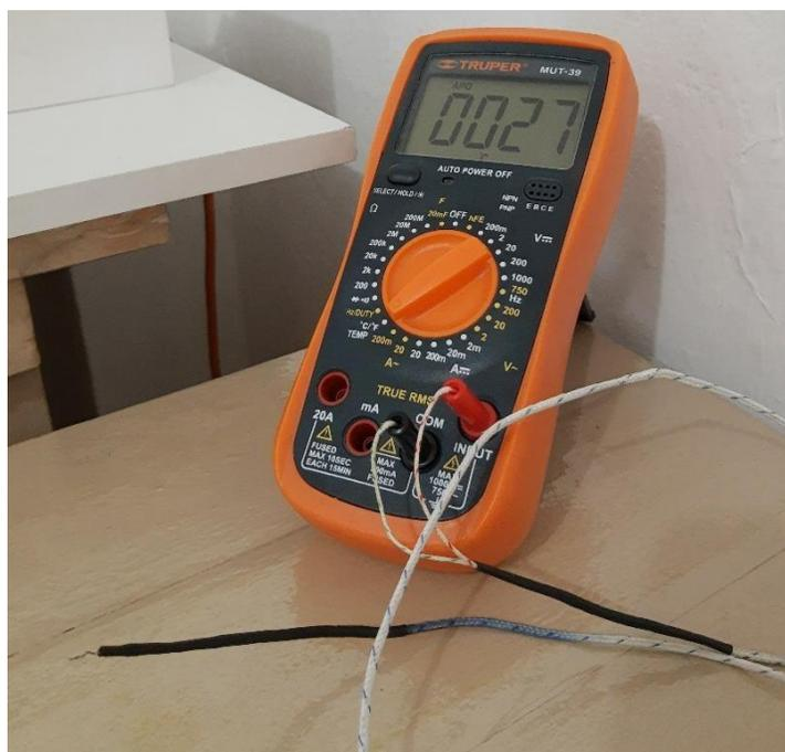
Figura 20. Termómetro digital por termocupla tipo K.
