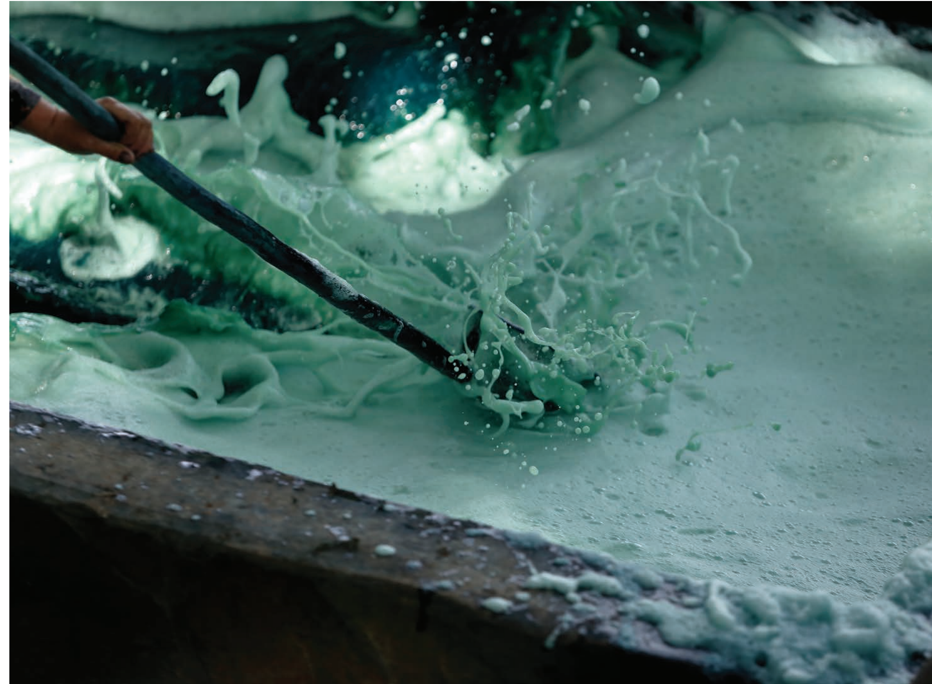
Proceso de oxigenación del agua en la extracción del tinte de añil, hacienda Los Nacimientos, Suchitoto, Cuscatlán.
