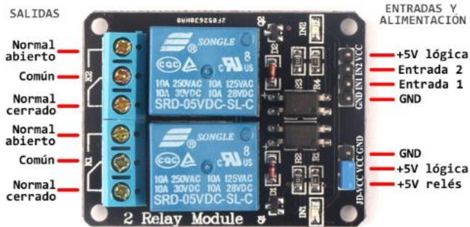
Los seis pines en el lado izquierdo del módulo del relé controlan voltaje alto, y los pines en el lado derecho se conectan al componente que entrega bajo voltaje, como los pines digitales de un Arduino u otro microcontrolador.
