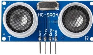
El tiempo que se tarda la onda en hacer esta trayectoria es convertido en una señal eléctrica, para que luego esta señal sea interpretada por algún controlador en el cual se realizan ciertas operaciones para determinar la distancia.
