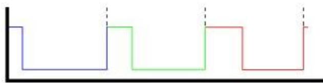
Ilustración 9: PWM PARA RECORRER TODO EL RANGO DE OPERACIÓN DEL SERVO
