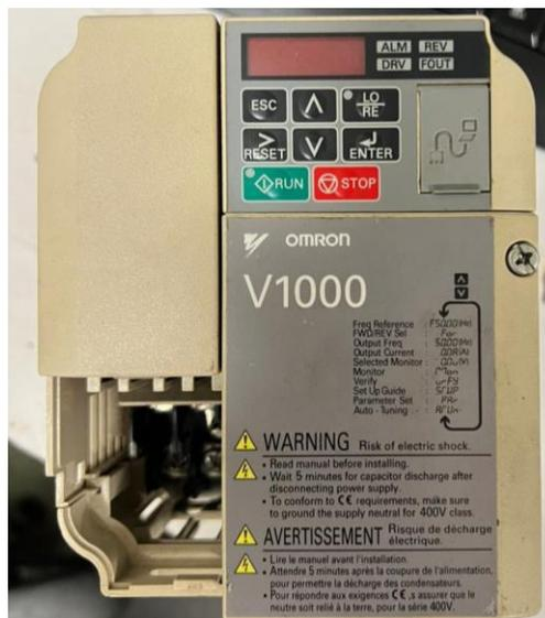
Figura 63 Variador Omron V1000
