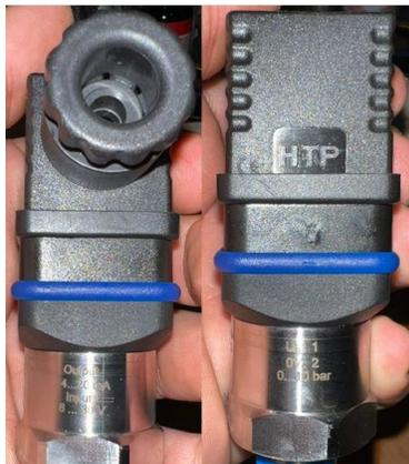
Figura 62 Sensor de presión industrial 0 - 10bar
