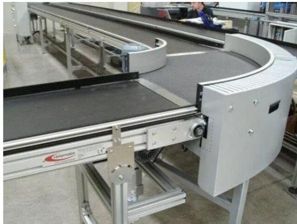
Ilustración 8: Banda transportadora Plana
