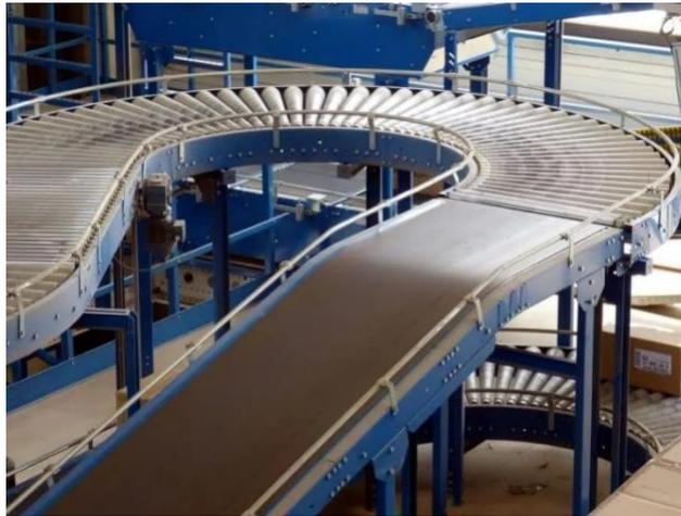
Ilustración 9: Banda transportadora de rodos, con caída por gravedad
