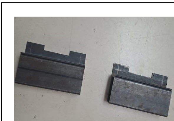
Fabricación de alzas de amortiguador.
