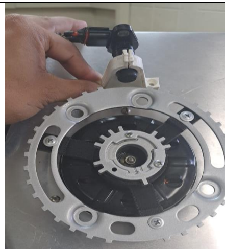
Instalacion de bases de porta sensores.
