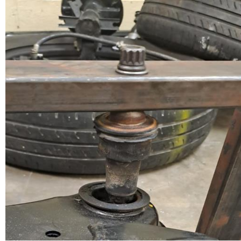
Instalación de pernos en puente inferior.
