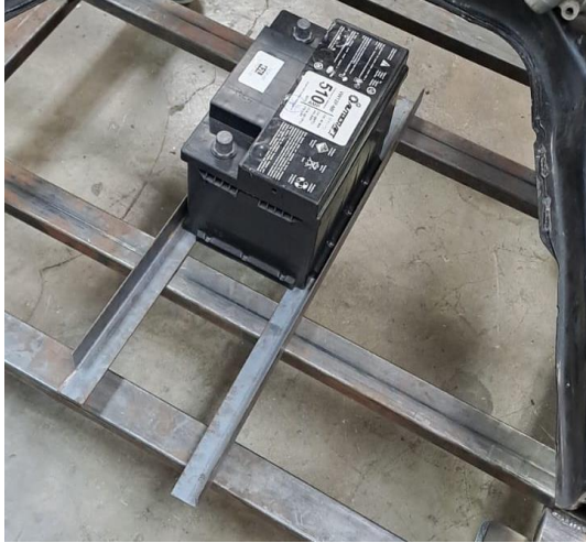
Instalación de base porta batería.
