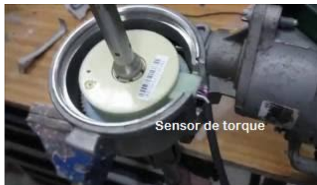
Fig. 19. Ubicación del sensor de torque.
