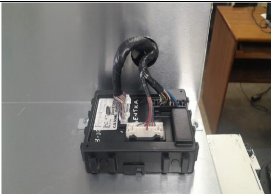
Instalación de modulo BCM.
