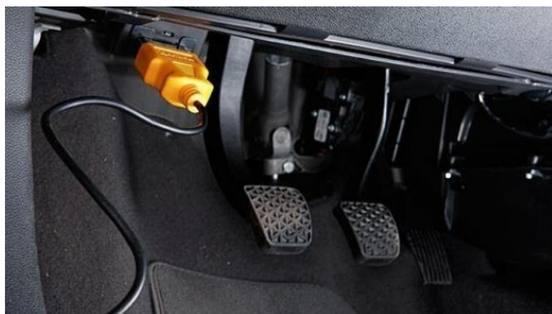
Fig. 7. Ubicación del conector de enlace de datos DLC (Data link Conector).
