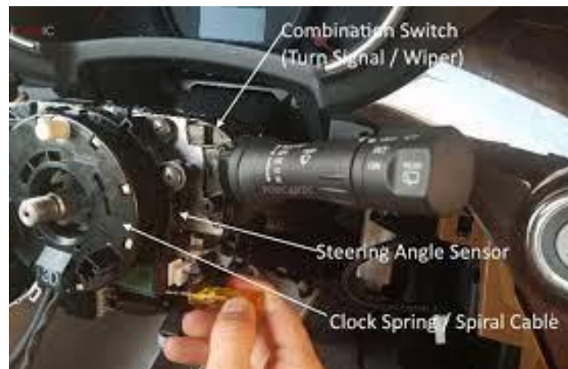
Fig. 17. Ubicación del sensor de ángulo de dirección.
