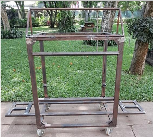
Instalación de rodos.
