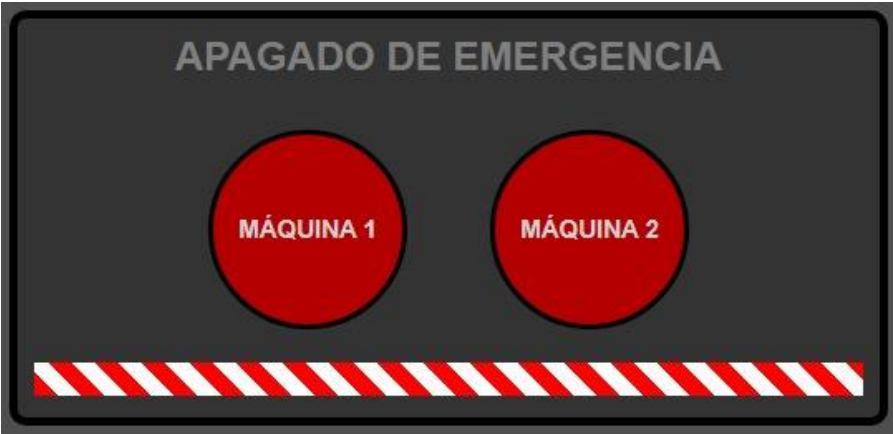
Fig. 36. Botones Apagado de Emergencia. (a) Máquina 1, (b) Máquina 2.
