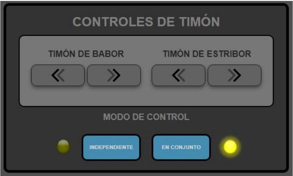
Fig. 35. Controles de Timón. (a) Timón de babor, (b) Timón de estribor, (c) Modo de control.
