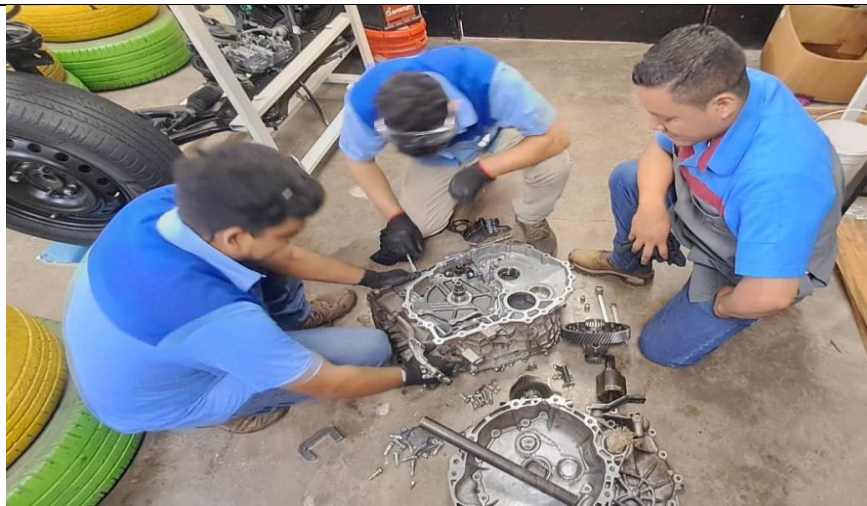
Desarmado de transmisión para extracción de cuerpo de válvulas.
