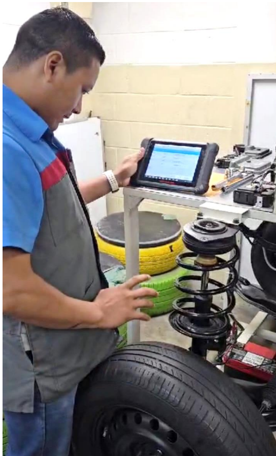
Comprobando comunicación del módulo de transmisión TCM.
