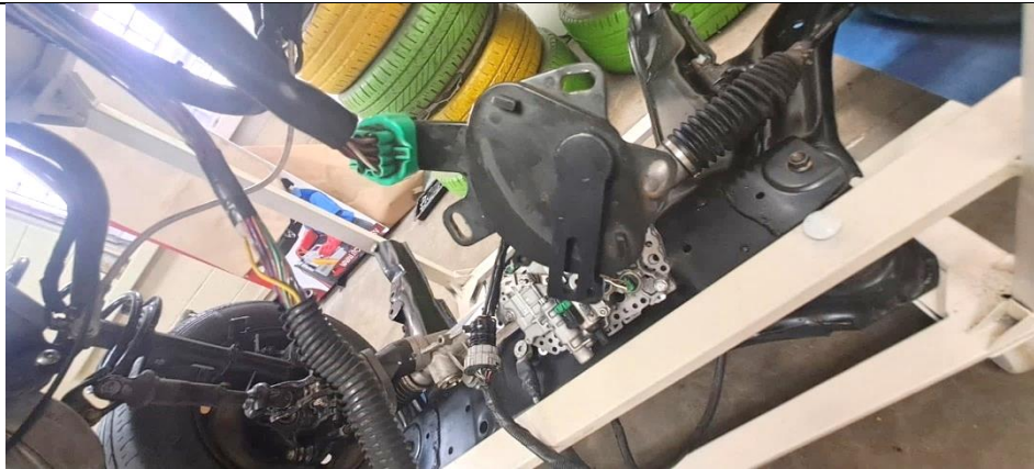
Prueba electrica de selectora de velocidades.
