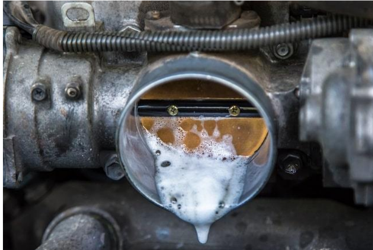
Fig. 5 Proceso de limpieza del cuerpo de aceleración.
