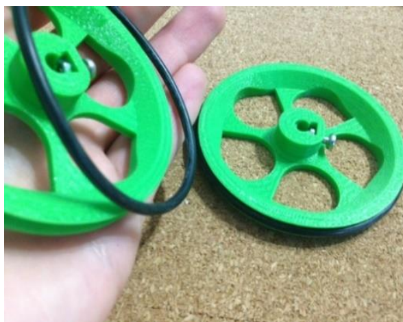
Figura 29. Colocación de o-ring
