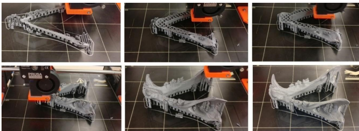
Figura 19: Proceso de impresión de la mandíbula.
