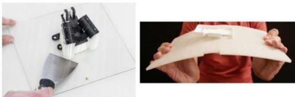
Figura 9. Formas de extraer la pieza impresa.
