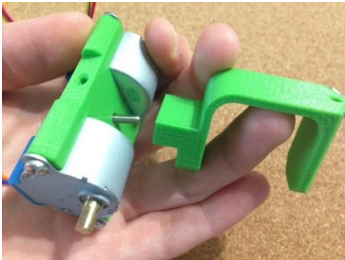
Figura 4. Soporte de los motores
