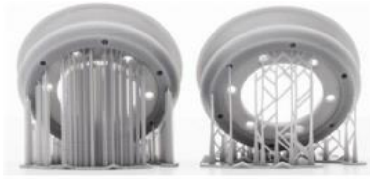
Figura 5. Representación de soportes en impresión 3D.
