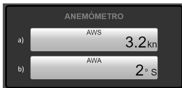
Fig. 7. Indicador anemómetro, (a) Indicador de velocidad de viento aparente, (b) Indicador de ángulo de viento aparente-
