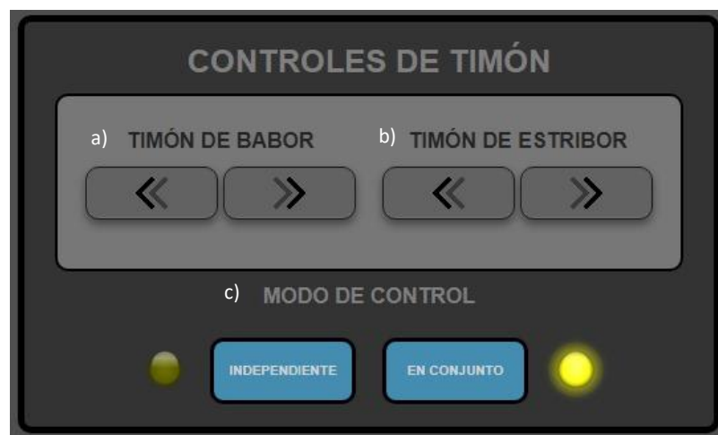
Fig. 9. Controles de Timón. (a) Timón de babor, (b) Timón de estribor, (c) Modo de control.
