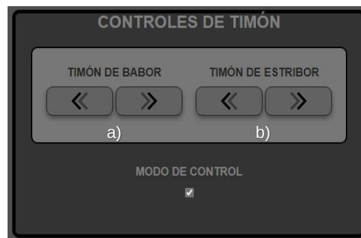
Fig. 3. Controles digitales de Timones. (a) Timón de babor, (b) Timón de estribor
