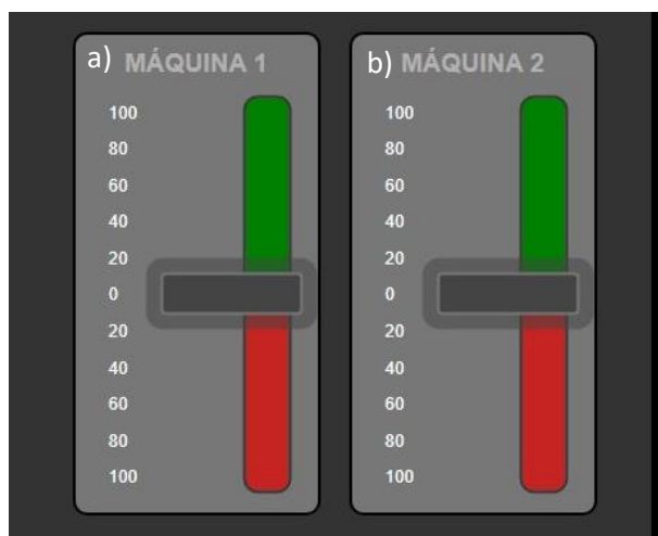
Fig. 5. Controles de mando de aceleración de motores. (a) Control de aceleración motor izquierdo, (b) Control de aceleración motor derecho
